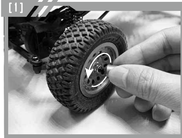
[1] Remove the wheel cap anticlockwise. 以逆時針旋扭將輪框蓋取下。
