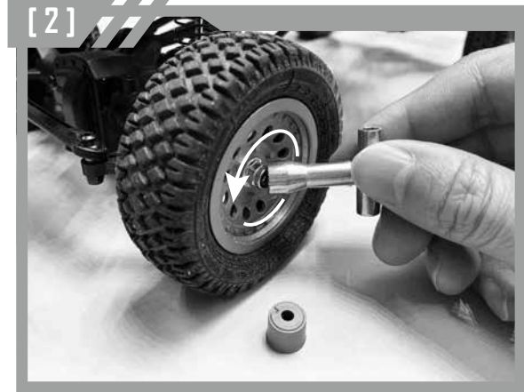
[2] Remove wheel lock nut using the Xwrench and detach wheels. 使用內附之六角螺帽套筒扳手將輪軸上六角固定螺帽取下。
